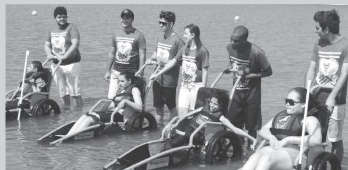
Feitos de alumínio, os equipamentos têm pneus especiais que flutuam, não afundam na areia e dispõem de uma barra para auxiliar a movimentação ou entrada e saída da água. A cadeira anfíbia só pode ser utilizada com acompanhamento facilitador e com acompanhante, independentemente da condição física do usuário.
